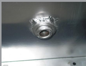
Vidange du collecteur de produit (filetage NPT)
